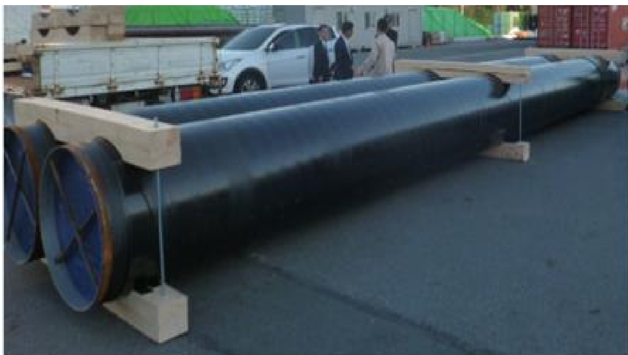
Пример упаковки труб большого диаметра, при транспортировке в контейнерах.
