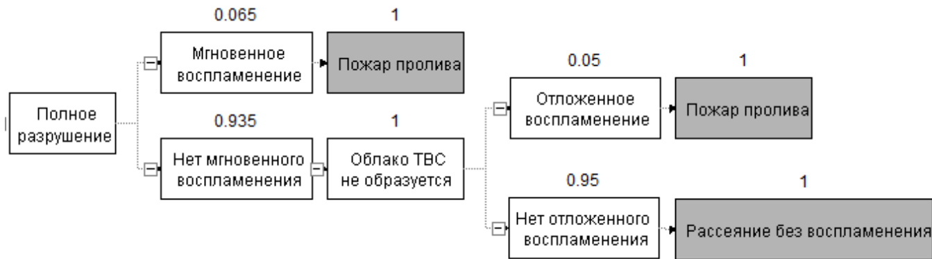
Рисунок 135 - Гильотинный разрыв технологического трубопровода на эстакаде, давление насыщенных паров менее 10 кПа
