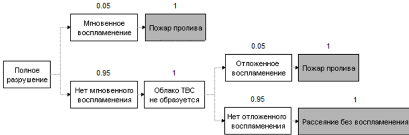
Рисунок 146 - Полное разрушение наземной емкости под давлением, давление насыщенных паров менее 10 кПа, стабильная жидкость
