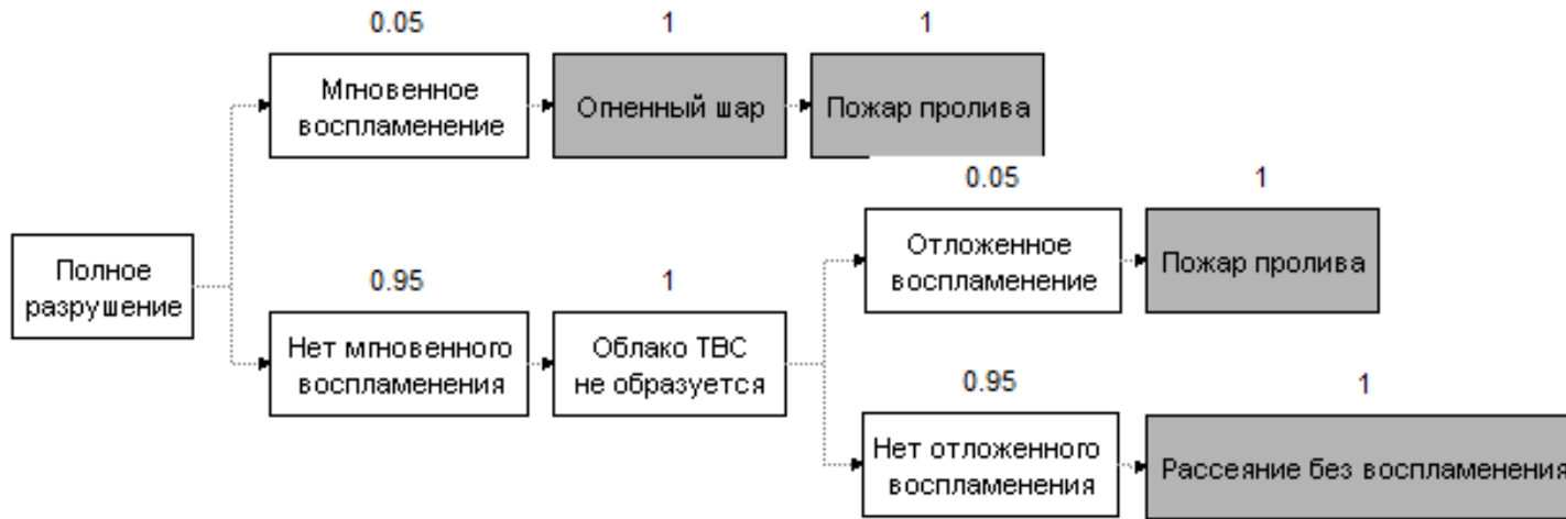
Рисунок 144 - Полное разрушение наземной емкости под давлением, давление насыщенных паров менее 10 кПа, нестабильная жидкость
