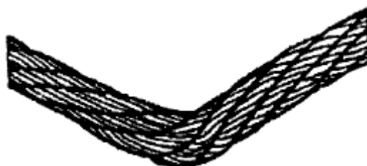
Рисунок 20. Перегиб каната.
