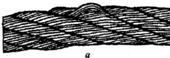
Рисунок 14. Выдавливание сердечника.
