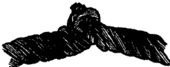
Рисунок 18. Перекручивание каната.
