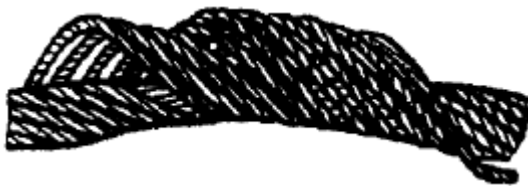
Рисунок 13. Корзинообразная деформация.
