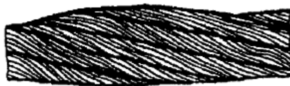
Рисунок 16. Местное увеличение диаметра каната.
