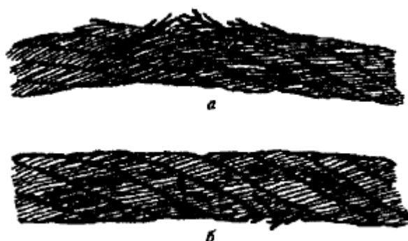
Рис. 5. Обрывы проволок в зоне уравнильного блока:
