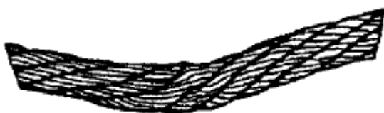
Рисунок 19. Залом каната.
