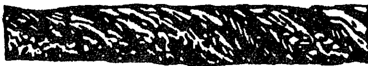
Рис.13.Перекручивание каната.
