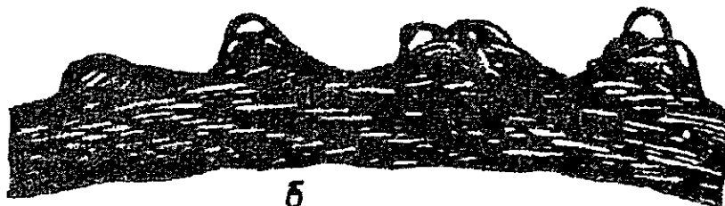
Рис. 10. Выдавливание проволок прядей. а - в одной пряди; б - в нескольких прядях.
